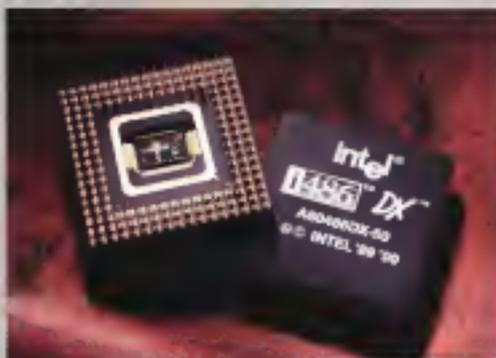
seguenze di 60, la CPU 486DX-50 ha dimensioni (dal silicio) che sono la metà rispetto a quelle delle versioni a 25 e 33 MHz.
